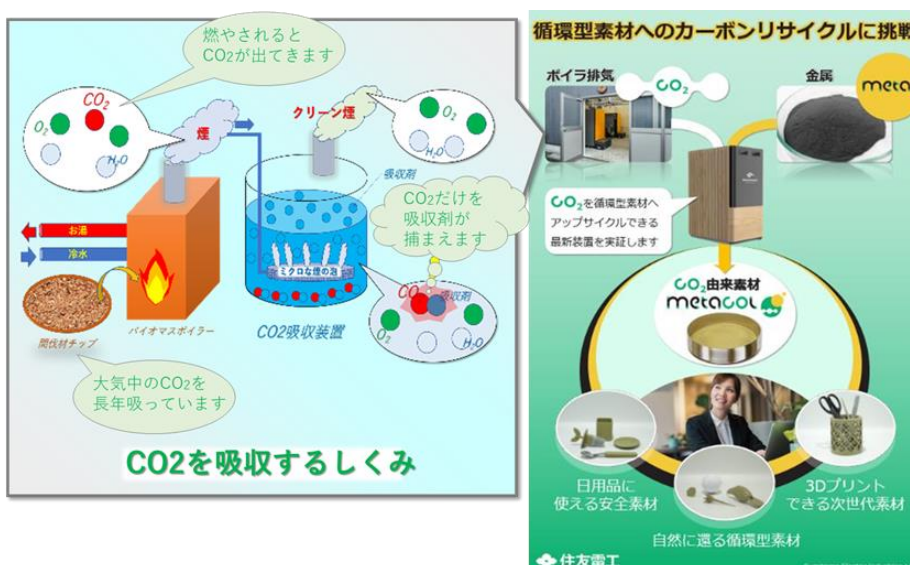
本ボイラーにおける CO2 削減の仕組み（概念図）
